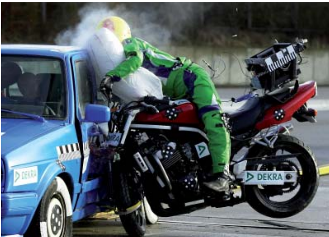
Modelfoto af motorcykel med airbag. Foto: DEKRA
